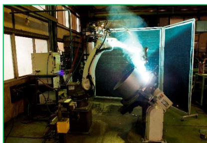
ロボット溶接機
