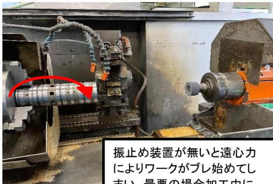
振止め装置が無いと遠心力によりワークがブレ始めてしまい、最悪の場合加工中にワークが外れてしまい重大事故に繋がります
